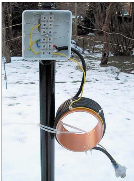
Bild 5: Anschlusskasten und Leitungsbalun; die Buchse gestattet Messungen direkt am Speisepunkt, d.h. nach dem Balun.
