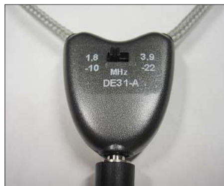
Bild 4: Antennenkopf mit Abstimm-diode und Verstärker. Abgebildet ist die neue Zweiband-Version (1,8 bis 10 und 3,9 bis 22 MHz), die erst nach Testende lieferbar wurde.
