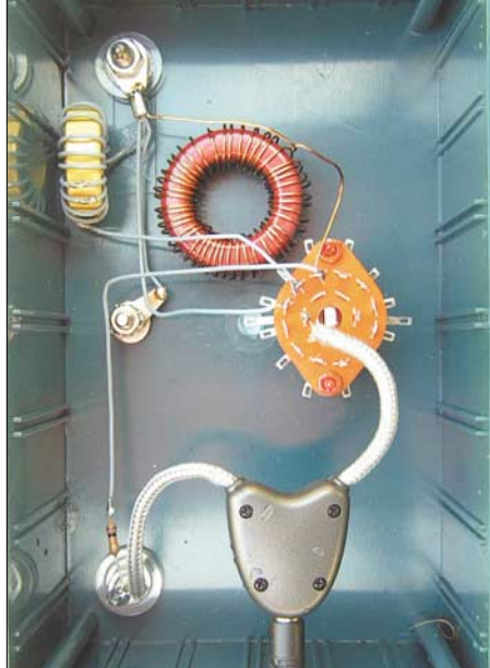
Bild 12: Blick aufs Innenleben der Umschaltbox. Unten liegt der eingelötete Antennenkopf der DE 31.
