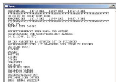
Bild 4: Der Deutsche Wetterdienst überträgt auf Lang- und Kurzwelle Wetterinformationen in RTTY.
