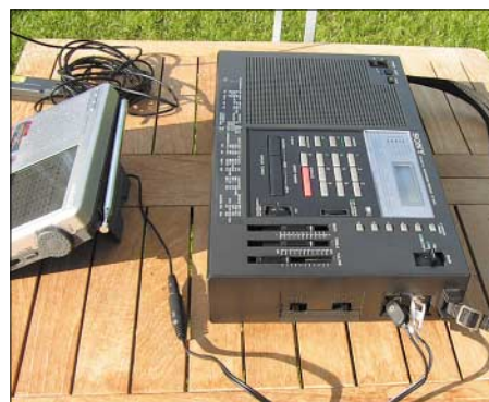
Bild 3: Zum Anschluss von Empfängern ohne Antennenbuchse gehört ein Adapter zur Einspeisung per Teleskopantenne zum Lieferumfang. Fotos: DJ1UGA (11); MicroConsult (1)
