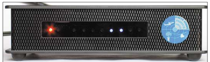
Bild 2: In der SBS-1-Basisstation stecken Empfänger und Decoder für digitale Flugzeugsignale.
